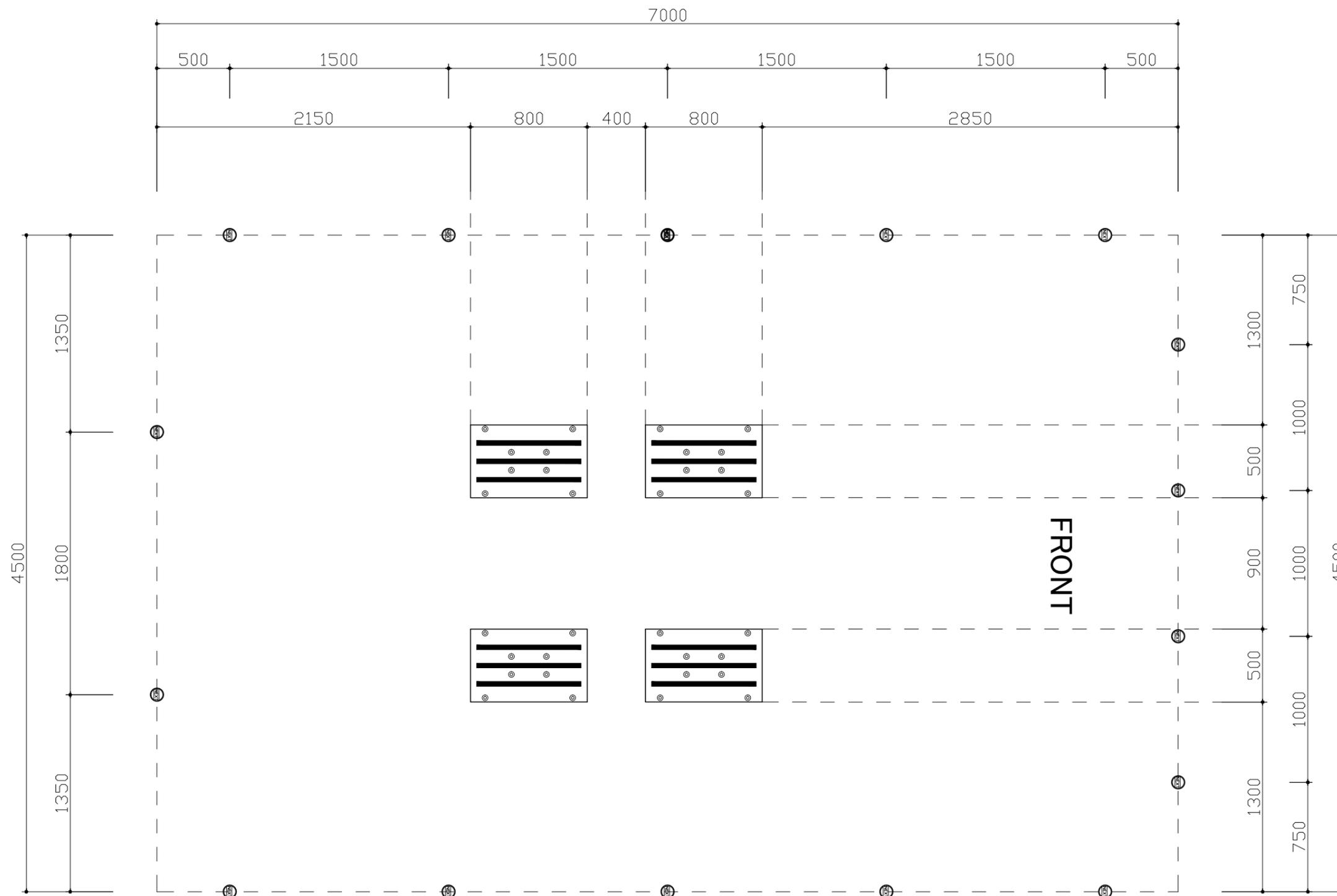
※本設備はコンクリートの厚みが十分にある場所に設置して下さい。(コンクリート強度・鉄筋の有無により条件が異なります)
