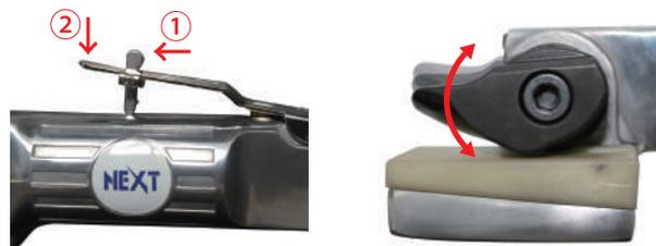
スイッチの安全装置を前側に倒しながらスイッチを押して下さい。右図のようにブレードが動きます。
