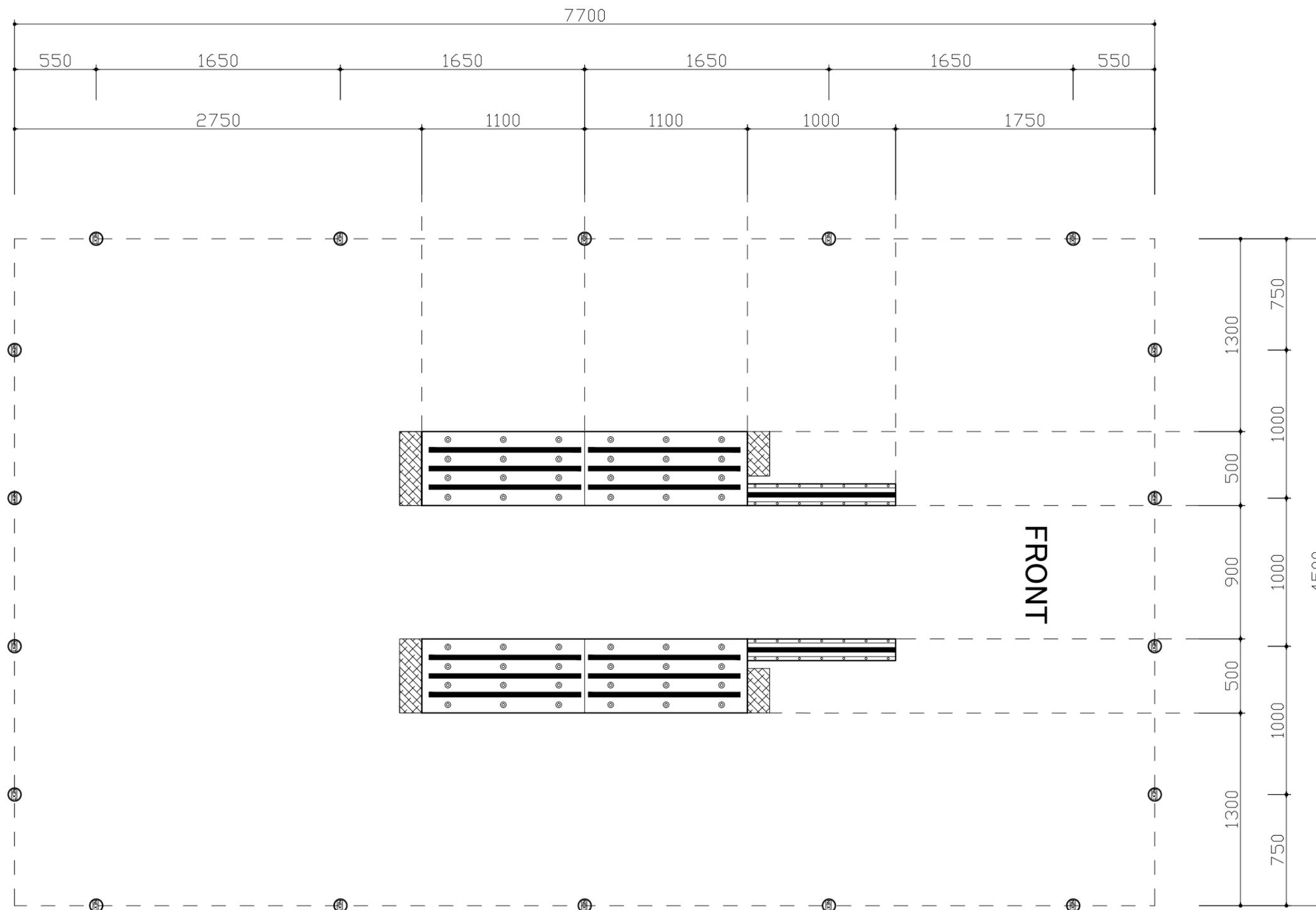
※本設備はコンクリートの厚みがある場所に設置して下さい。(コンクリート強度・鉄筋の有無により条件が異なります)
