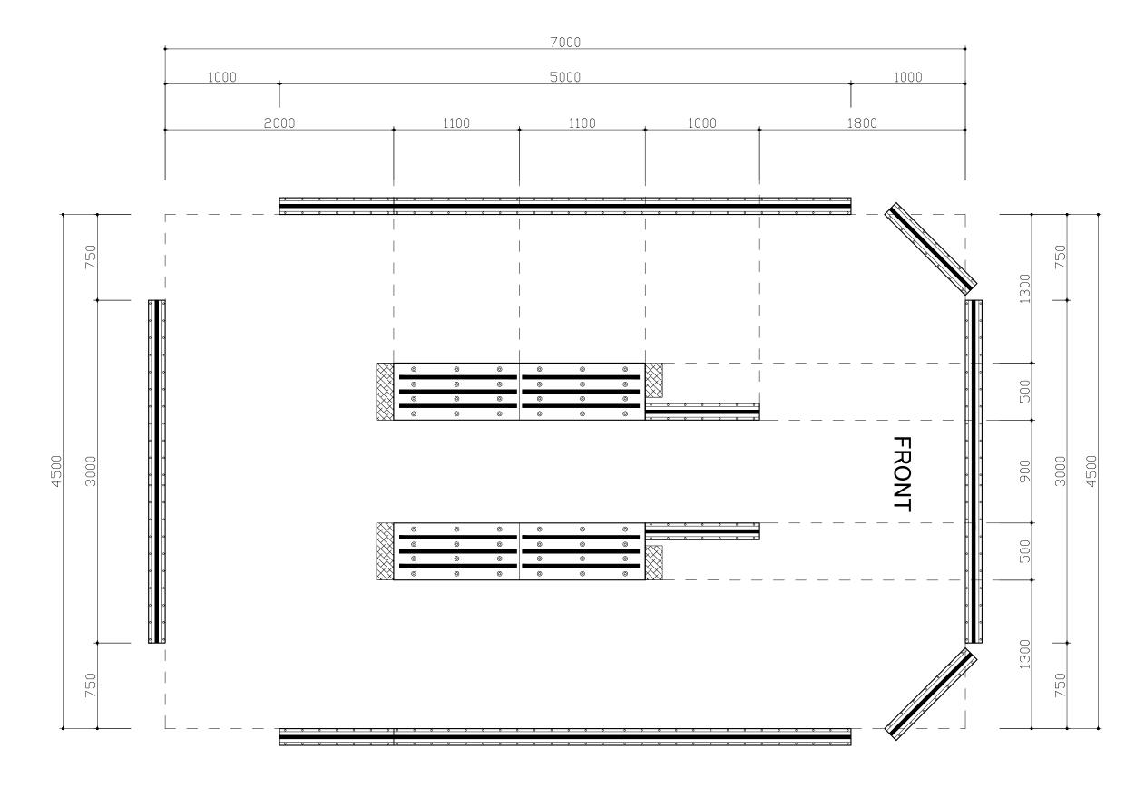
※本設備はコンクリートの厚みが十分にある場所に設置して下さい。(コンクリート強度・鉄筋の有無により条件が異なります) ※コンクリの強度確保の為、アンカー類はコンクリの切れ目より300mm以上離して設置して下さい。
