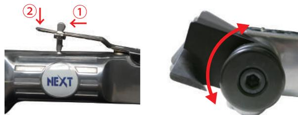
スイッチの安全装置を前側に倒しながらスイッチを押して下さい。右図のようにブレードが動きます。
