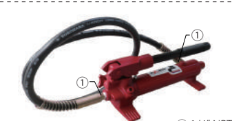
① 1/4" NPT P-4H 4トン手動ポンプ 最大圧力：69.9MPa (713kgf/cm 2 ) カブラ：BH-14 / 油量：300cc / 重量：4.4kg 吐出油量：2.8 ml (ストローク)
