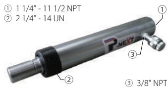
① 1 1/4" - 11 1/2 NPT ② 2 1/4" - 14 UN ③ 3/8" NPT RCX-200 10トンロングラム 全長：388～628mm / カブラ：BR-38 プランジャー径：32mm / 重量：5kg
