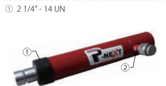
① 2 1/4" - 14 UN ② 3/8" NPT RS-150 10トンスナップオンラム 全長：522～675mm / カブラ：BR-38 プランジャー径：33mm / 重量：5.5kg
