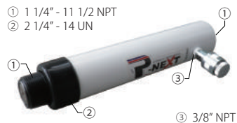
① 1 1/4" - 11 1/2 NPT ② 2 1/4" - 14 UN ③ 3/8" NPT RCX-150 10トン標準ラム 全長：302～458mm / カブラ：BR-38 プランジャー径：42.8mm / 重量：5kg
