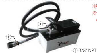
① 3/8" NPT APX-10T エアーポンプ 最大圧力：68.0MPa (703kgf/cm 2 ) カブラ：BH-38 / 油量：16ℓ / 重量：7.3kg 吐出油量：1250 ml (無負荷時)
