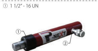
① 1 1/2" - 16 UN ② 1/4" NPT RS-100 4トンスナップオンラム 全長：272～399mm / カブラ：BR-14 プランジャー径：22.2mm / 重量：2kg
